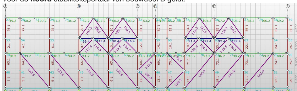
Figuur 28| Schematisering stabiliteitsportaal noord bouwdeel B
