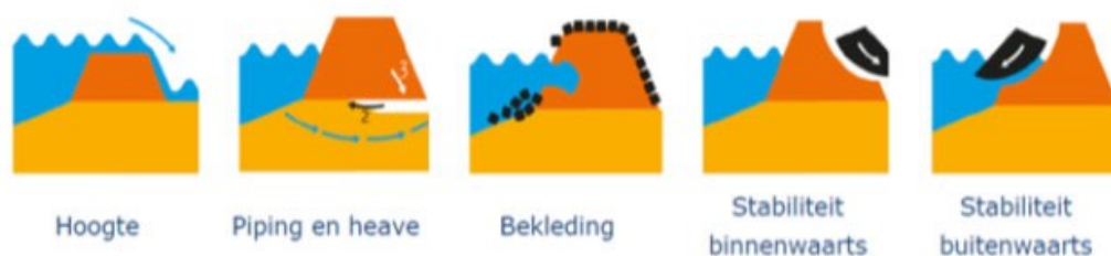
Figuur 0.1 Werking van de verschillende faalmechanismen
