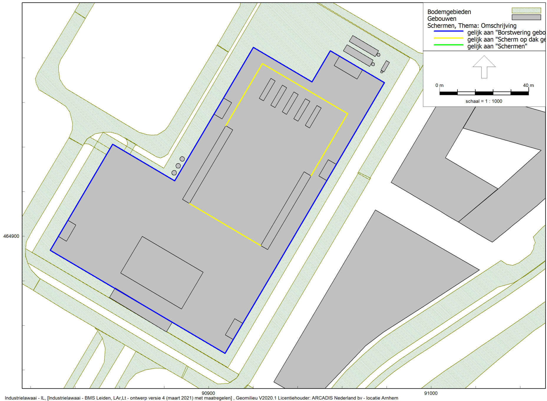
Overzicht ligging afschermdende maatregel Geluidscherm op dak gebouw, 3 m hoog en ca. 150 m lang
