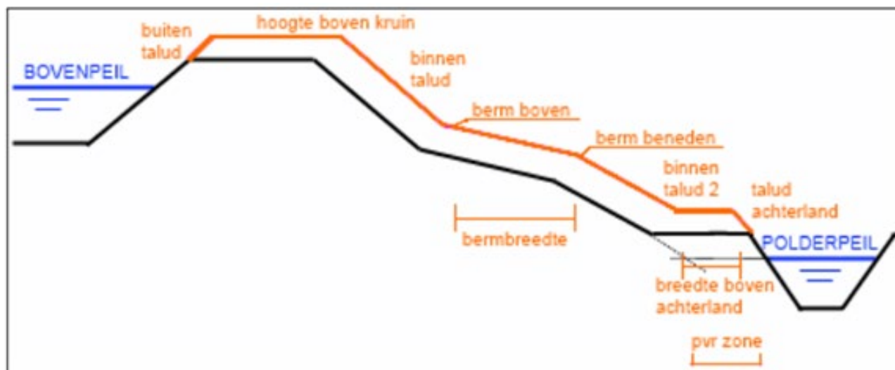
Figuur B4- 4 Schematisch overzicht van het leggerprofiel (zwarte lijn) en het profiel van vrije ruimte (oranje lijn) met bijbehorende terminologie
