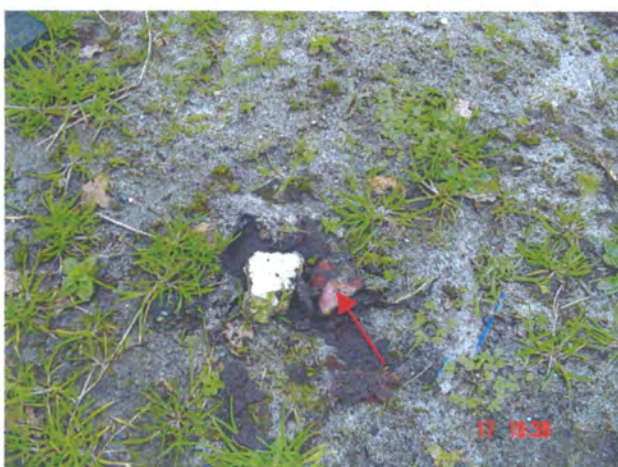
Foto 5: Asbesthoudende golfplaat op maaiveld
