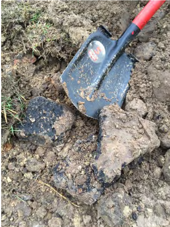
Voorkomen asfalt in de grondstrook tussen de voormalige kippenschuren
