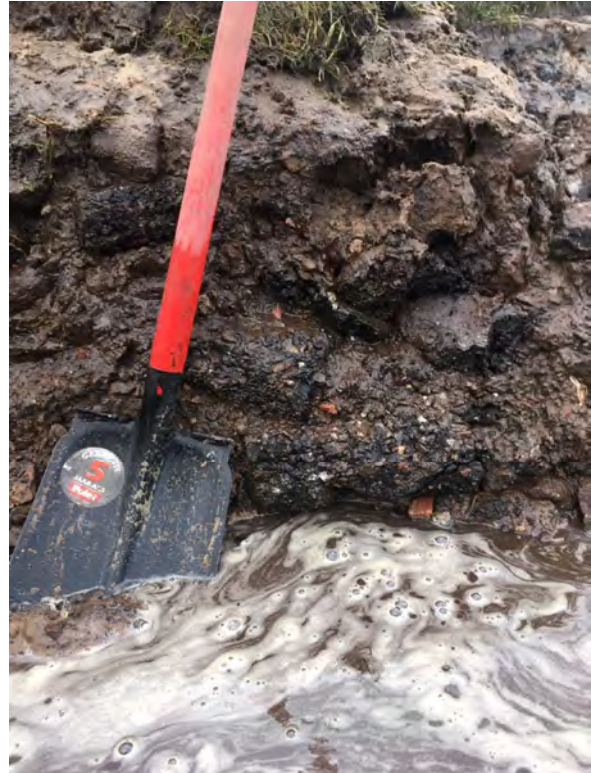
Voorkomen asfalt in de grondstrook tussen de voormalige kippenschuren
