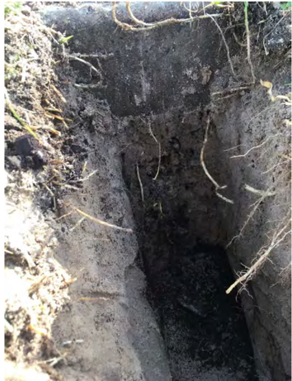
Geen bodemvreemde bijmengingen onder/naast stelconplaat bij de brug
