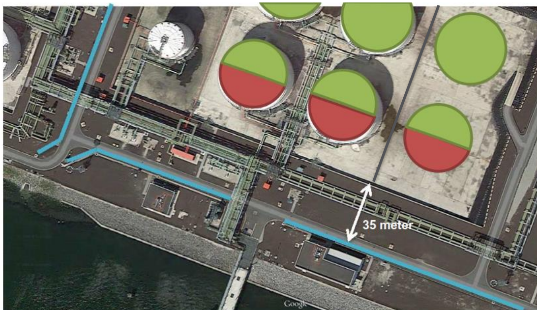
Figuur 5: Overzicht tankputten 40-2 en 40-4 – [lichtblauw: hemelwaterriool (HWA), rood: uitstroom richting HWA, groen: uitstroom richting ander procesgebied/ tankput]
